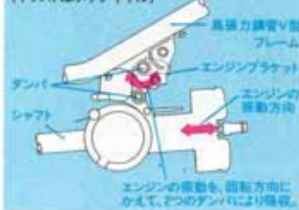
バイブレスリンク式エンジン懸架方式 (イラストはポップギヤル)
