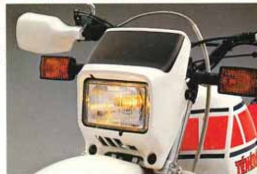
角形12V60/55Wの ビッグなハロゲンヘッドランプ。
