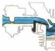
また定評のY.I.C.S.(ヤマハ・インダクション・コントロール・システム)を搭載。ヤマハが誇る2段電子進角式フルトランジスタ点火ともあいまって、抜群の燃焼効率を実現。ノッキングの防止、中低速性能の向上、そして42km/ℓ(60km/h定地走行テスト、運輸省届出値)という低燃費をマークしたのです。
