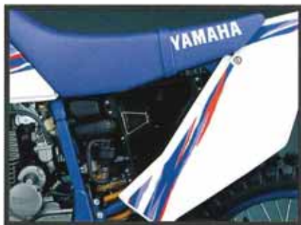
回転式サイドカバー&クイックリリースエアクリナーカバー
