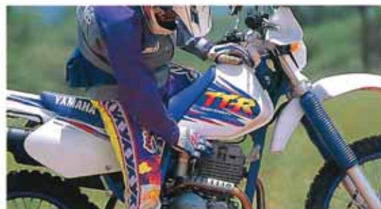
タイヤはアルミリム：フロント21インチ、リア18インチを採用。リムは、ホディカラーに合わせたアルマイト着色。オープンエンデュランスとして、ひと味が違う個性を放っている。
