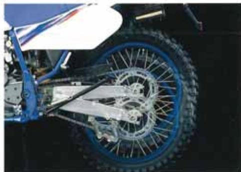
ホイールトラベル：フロント、リアともに280mmを確保。優れた減衰力特性と相まってジャンプ落地時のフルボトム限界を高めている。また、フロントには圧側20段、リアには圧側20段、伸側40段の減衰力調整機構が備えられている。
