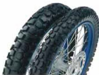
タイヤはアルミリム：フロント21インチ、リア18インチを採用。リムは、ホディカラーに合わせたアルマイト着色。オープンエンデュランスとして、ひと味が違う個性を放っている。
