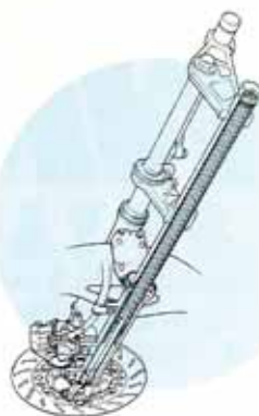
※7 フロントサスペンション フロントサ スペンションのインナーチューブは、33φの 大径。しかもヤマハが誇るモトクロッサー YZのものと同じ材質を採用して、高い 剛性と軽量化の両立をはかりました。
