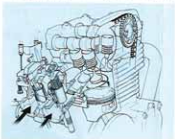
※4 Y.D.I.S. 中低速で鋭いピッチアップをもつ強制閉閉式のアマルタイプキャブレターと、高速域でスムーズなSUタイプのキャブレターを組み合わせたヤマハ独創の吸気システム。すべての速度域でスロットルレスポンスを向上する。
