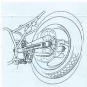
*8 ニューリンク式モノクロスサスペンション リアアームとクッションユニットの間にリン ク機構を設けたもの。通常走行時にはソ フトに、中間ストロークでは徐々に硬く、そ して大きなショックには強くダンパーが働き、 低重心化、重量マスの集中化にも貢献。
