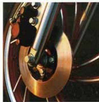
油圧式フロントディスクブレーキ：すぐれた制動性能、洗練のタッチ感覚。
