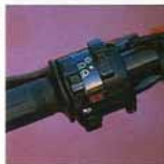
ハンドルスイッチ：すばやく正確な操作を可能にする。簡潔なスイッチレイアウト。また、クラッチレバーは従来の少ないバウンスタイプ。
