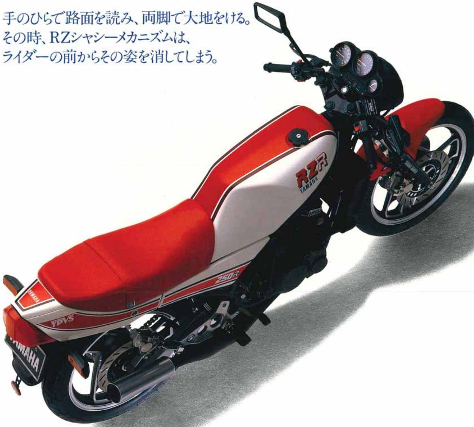
**フレーム:**ビュースポーツというからには、パワーユニットと同じようにシャシーにも速さが求められる。中でもいま注目の的はフレームだ。RZ250R／RRは、高張力鋼管製ワイドフレーム。TZにきわめて近いそのパイプワークは、剛性と強度を巧みにバランスさせながら、できる限りの軽量化を追求。低重心・マス集中化の容易なRZならではの軽量・小型2ストロークエンジンと相まって、素直でシャープな操縦安定性を支えている。
