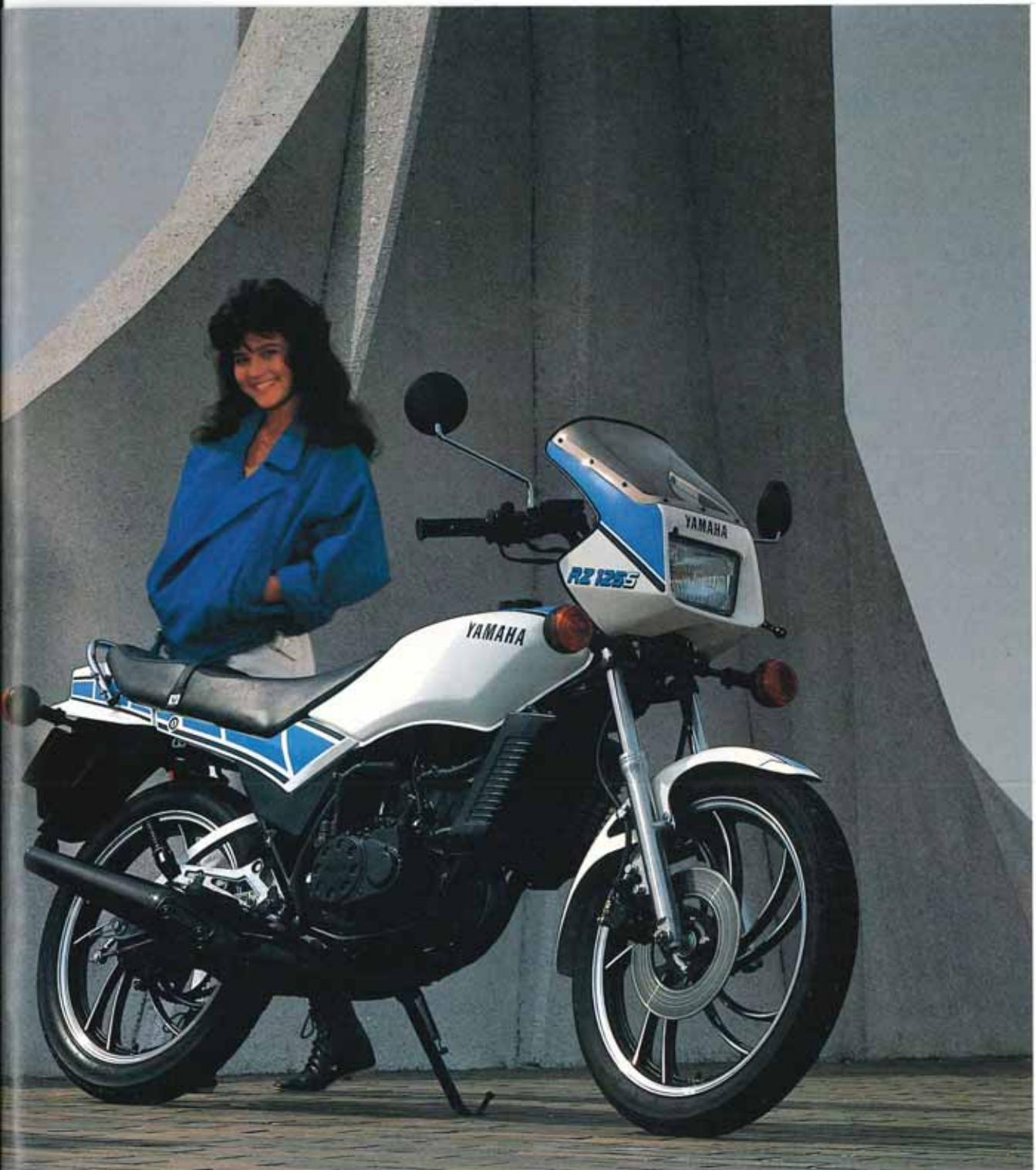
RZの直系。ハイパワーと扱いやすさの水冷2ストロークエンジン。RZ125Sは、その名にふさわしく、市販ロードレーサーTZのレーシングテクノロジーを継承する水冷2ストロークエンジンを搭載。本来の高いポテンシャルをベースに、吸気効率の向上を追求した吸気ポート形状などによって、実際に22ps/9,500rpmというハイパワーを発揮します。同時に、低中速域での扱いやすさも実現。また、一軸式バランサー、いわゆるダイナミックバランサーの採用により、全回転域にわたって、振動を打ち消しています。多段膨張式マフラーと相まって、静かで滑らかなライディング感を実現しました。水冷方式は、アルミ製コルゲートフィン型ラジエーターと、クラシックケース右側にセットしたウォーターポンプからなる軽量コンパクト設計。長時間走行にもパワーダウンのない安定したパフォーマンスを発揮します。オイル消費の少なさ、メカニカルノイズの低さも特長です。また、暖機を早め、オーバークールを防止するサーモスタット機構や、補水などメンテナンスの楽なツヤーブタンクも備えています。
