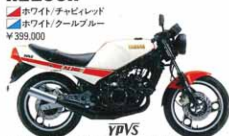
●2サイクル 水冷 ●45馬力 ●リターン式6段
