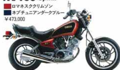
●4サイクル OHC ●40馬力 ●リターン式5段 ●シャフトドライブ
