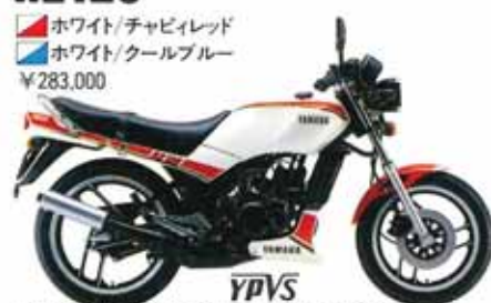
●2サイクル 水冷 ●22馬力 ●リターン式6段
