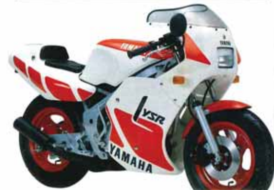
●2サイクル 水冷 ●7.2馬力 ●リターン式6段
