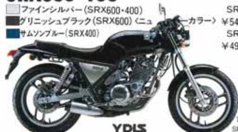
●4サイクル OHC ●42馬力 (400c.c.は33馬力) ●リターン式5段
