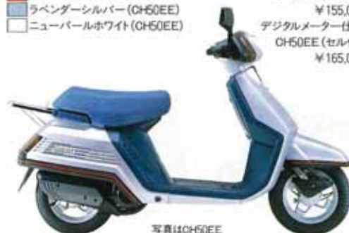
写真: CH50EE ●2サイクル●5.5馬力●Vベルト自動無段変速
