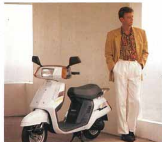
●2サイクル 水冷 ●16馬力 ●Vベルト自動無段変速
