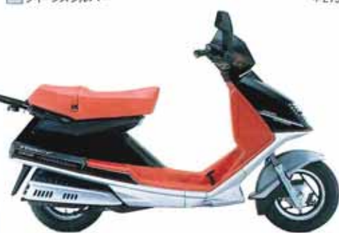
●2サイクル 水冷 ●16馬力 ●Vベルト自動無段変速
