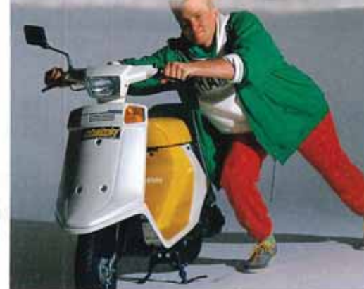
●2サイクル ●3.8馬力 (80c.c.は5.0馬力) ●Vベルト自動無段変速
