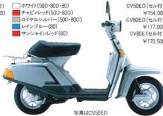
●2サイクル ●3.8馬力(80ccは5.0馬力) ●Vベルト自動無段変速
