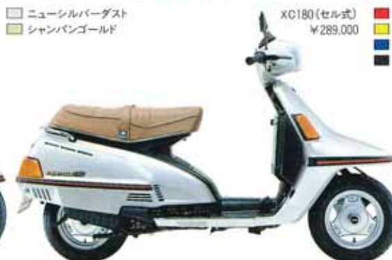
●4サイクル ●15馬力 ●Vベルト自動無段変速
