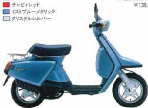
●2サイクル ●3.6馬力 ●Vベルト自動無段変速
