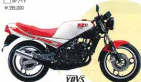
●2サイクル 水冷 ●45馬力 ●リターン式6段
