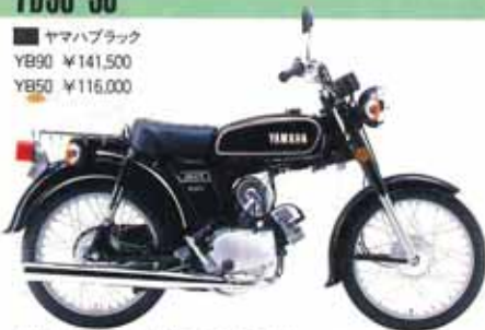
●2サイクル ●7.5馬力(50ccは4.8馬力) ●ロータリー式4段 写真は YB50
