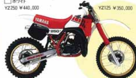
●2サイクル 水冷 ●44馬力 (125ccは32馬力) ●リターン式5段 (125ccは4段)
