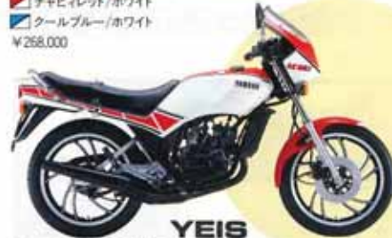
●2サイクル 水冷 ●22馬力 ●リターン式6段
