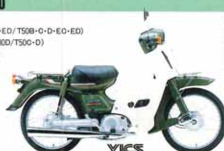
●4サイクル ●6.7馬力(50ccは5馬力) ●ロータリー式3段(T50C-EOはロータリー式4段) 写真は T50C
