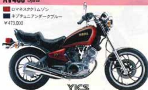
●4サイクル OHV ●40馬力 ●リターン式5段 ●シャフトドライブ
