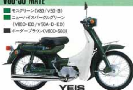
●2サイクル ●6.7馬力(50ccは4.7馬力) ●ロータリー式3段(V50Aはオートマチック2段) 写真は V50D
