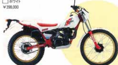
●2サイクル ●14馬力 ●リターン式5段 ●デューバック標準装備
