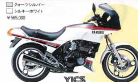
●4サイクル 水冷 DOHC ●55馬力 ●リターン式5段
