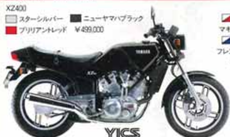
●4サイクル 水冷 DOHC ●45馬力 ●リターン式5段 ●シャフトドライブ
