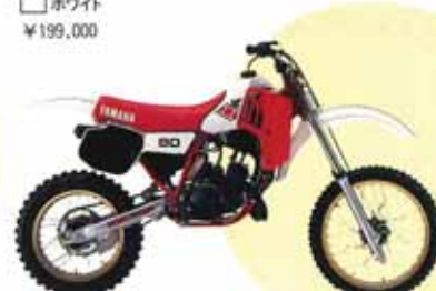
●2サイクル 水冷 ●21.5馬力 ●リターン式6段
