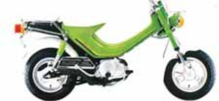
●2サイクル●3.6馬力●オートマチック3段変速(LE50A) ロータリー式3段(LE50C)
