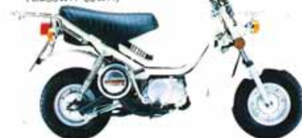
●2サイクル●3.5馬力(80ccは4.7馬力) ●Cは自動遠心クラッチ。 ロータリー式3段 Hはハンドクラッチ ロータリー式4段
