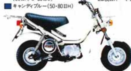
●2サイクル●3.5馬力(80ccは4.7馬力) ●Aはオートマチック、Cは自動遠心クラッチ、Hはハンドクラッチの3タイプ。
