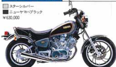
●4サイクル、OHC●60馬力●リターン式5段●シャフトドライブ
