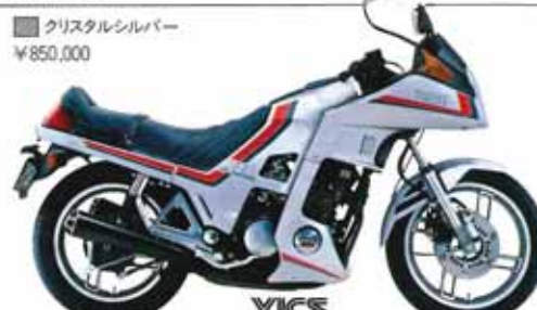
●4サイクル、DOHC●70馬力●リターン式5段●シャフトドライブ
