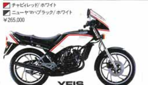
●2サイクル、水冷●22馬力●リターン式5段
