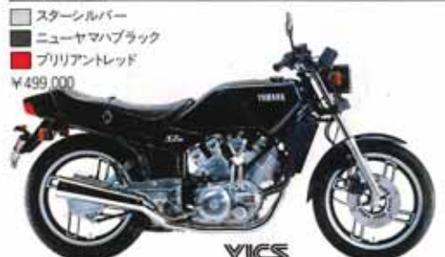
●4サイクル、水冷、DOHC●45馬力●リターン式5段●シャフトドライブ
