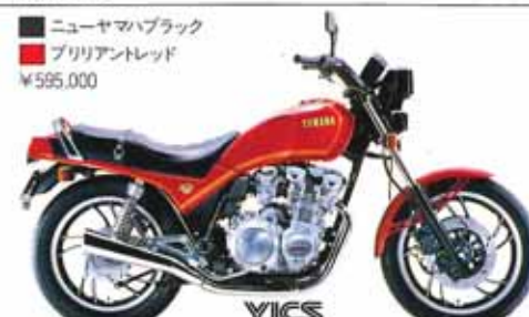
●4サイクル、DOHC●70馬力●リターン式5段●シャフトドライブ
