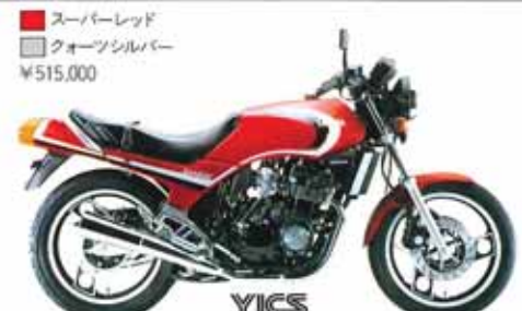
●4サイクル、水冷、DOHC●55馬力●リターン式6段
