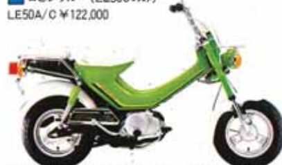
●2サイクル●3.6馬力●オートマチック3段変速(LE50A) ロータリー式3段(LE50C)
