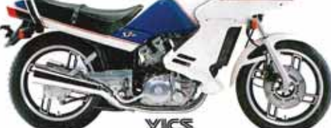
●4サイクル、水冷、DOHC ●45馬力 ●リターン式5段 ●シャフトドライブ
