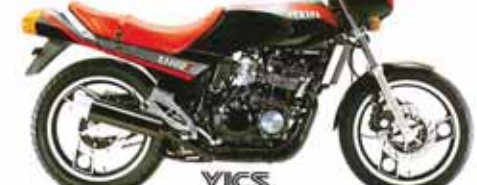
●4サイクル、水冷、DOHC ●55馬力 ●リターン式5段
