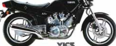
●4サイクル、水冷、DOHC ●45馬力 ●リターン式5段 ●シャフトドライブ
