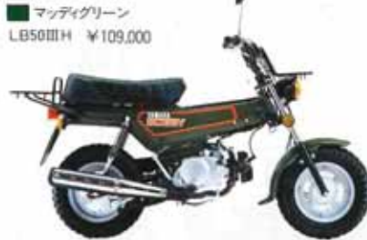
●2サイクル、空冷 ●3.7馬力 ●ロータリー式4段
