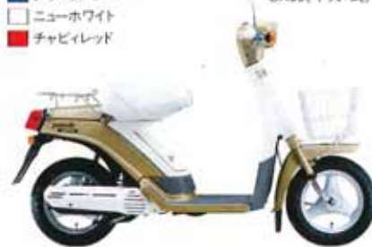
●2サイクル、空冷●2.8馬力●オートマチック2段変速
