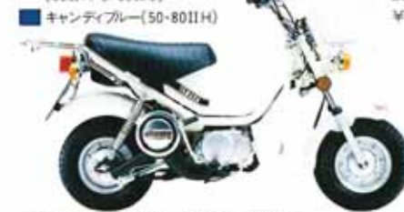
●2サイクル、空冷 ●3.5馬力(80ccは4.7馬力) ●オートマチック・自動連心クラッチ・ハンドクラッチの3タイプ ●コンベクションライトグリーンのシートはブラック仕様です。
