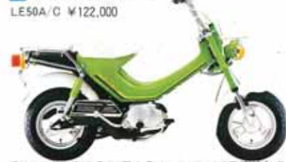
●2サイクル、空冷●3.6馬力●オートマチック3段変速(LE50A) ロータリー式3段(LE50C)
