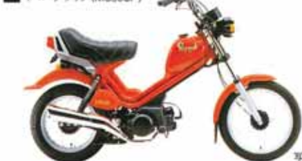
●2サイクル、空冷●3馬力●オートマチック2段変速
