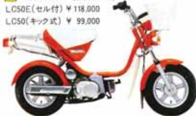
●2サイクル、空冷 ●2.8馬力 ●オートマチック2段変速
