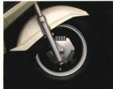
伝えるため、本格的なキャストホイールにはラジアルパターンのチューブレスタイヤを装着。ドライでもウェットでも、高いグリップ力を發揮します。またキャストホイールにはブレーキング時の熱を放出するためのフィンを設けました。そのブレーキは、強力なリーディング・
