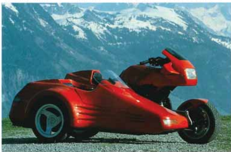
DUETTO エンジン形式：直列4気筒DOHC、総排気量：1092cc、最大出力：100ps/7500rpm、最大トルク：10.9 kg-m/5500rpm、乾燥重量：390kg、燃料タンク容量：38L、価格：¥6,400,000/¥6,900,000
