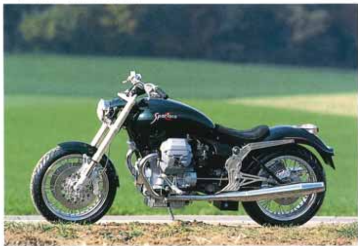
SPARTACO エンジン形式：縦置90度V型2気筒OHV、総排気量：1064cc、最大出力：90ps/7800rpm、最大トルク：9.7kg-m/6000rpm、乾燥重量：212kg、燃料タンク容量：18L、価格：未定
