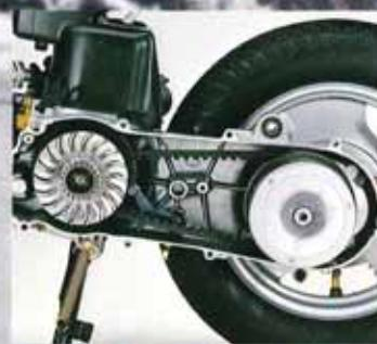
Vベルトドライブ方式とは、エンジン側、後輪側に設けられたブレーキがベルトをはさみ、遠心クラッチの圧力でブレーキを開閉させる
