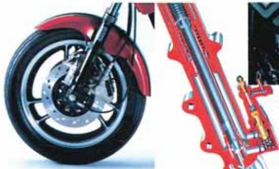
●シャープなコーナリング性能と、抜群の直進安定性を生み出す16インチのフロントホイールを装着しています。チャンピオン・マシンRGFからのノウハウを生かしたもので、グリップ力、ブレーキ性能など大幅な向上が可能となります。
