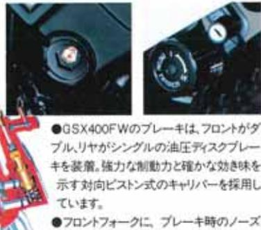
●GSX400FWのブレーキは、フロントがダブル、リヤがシングルの油圧ディスクブレーキを装着。強力な制動力と確かな効き味を示す対向ピストン式のキャリパーを採用しています。
