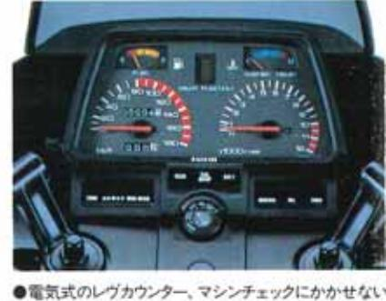
●電気式のレヴカウンター、マシンチェックにかかせないOKモニター、液晶のギヤポジション・インジケーターなど、機能性と視認性を重視したメーターです。
