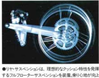
●リヤ・サスペンションは、理想的なクッション特性を発揮するフルフローター・サスペンションを装着。乗り心地が向上するとともに、走行性能が飛躍的に向上します。クッションユニットのスプリング・イニシャルを遠隔操作するための、RCPL(リモートコントロール・プリロード)機構を装備しています。
