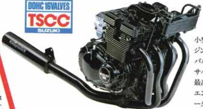
小型、軽量化を図りながら、ハイパワーを追求したエンジンです。DOHC・4気筒・16バルブ・TSCCエンジンで、バルブタイミングの変更、キャブレター口径の大径化、サイクロタイプ4 into 1マフラーの採用により、48馬力の最高出力を発揮します。
