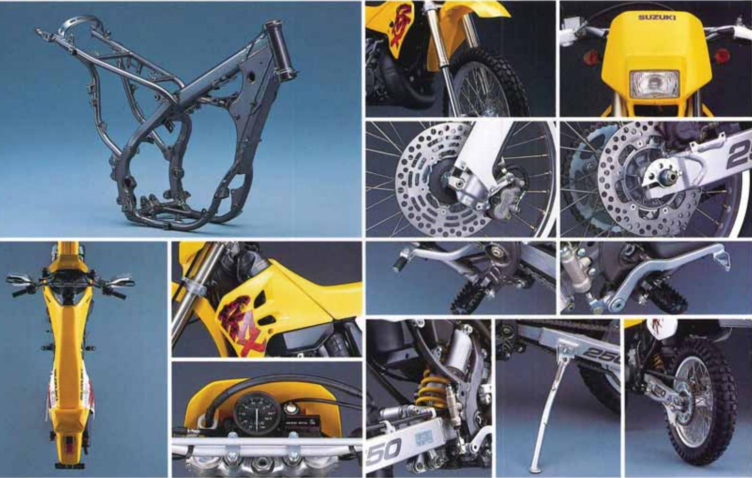
■限界特性を大きく高めたホイールトラベル300mmの倒立フロントフォーク。フロントにはすぐれた走破性を生むインナーロッド式倒立フロントフォークを採用(インナーチューブ径φ43)。基本的にはRMのメカニズムを踏襲しながらも、エンデューロの走行特性に応じたしなやかな剛性を追求。さまざまに変化する路面状況に応じて減衰力の調整が必要な圧側は18段階の調整が可能。ホイールトラベルも300mmと長大なストロークを持ちながら、アクスル下方への突き出しをわずかにすることで深いわだちでの高い走破性を獲得している。
