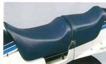
■RG250Γのシートは、快適な走行を約束します。シート高は785mmと足置き性に優れています。
