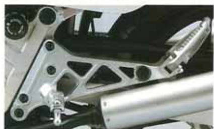
■マフラーブラケットは、軽量化をはかったアルミダイキャスト製で機能的なデザイン。ステップ・タンデムステップ、チェンジレバーはアルミ鍛造。
