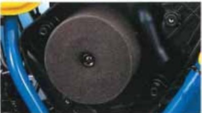
抜群の排気効率を誇り、燃焼効率を大幅に向上させるスズキ独自の多段膨張マフラー。排気管を段階的に膨張させることで、マフラー内の負圧を長く、大きくし、排気ガスの吸い出し効果を高めて排気効率を大幅に向上させています。また同時に、マフラー内の排気ガスの脈動で混合気の吹き抜けを防止し、高い燃焼効率を得るという、スズキ独自の画期的な排気メカニズムです。
