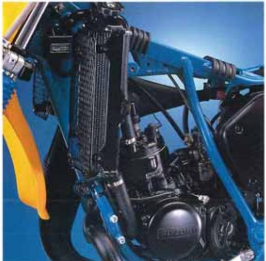
誇ります。吸気効率が高く、低・中速のピックトルクと高回転の伸びを同時に実現するスズキ独自のパワーリードバルブ、スキッシュエリアを持つ燃焼室、フリクションロスの少ない新開発薄型・軽量ピストンリング、メンテナンスフリーで低速から高速まで理想的な点火時期が得られるP.E.I.高速逕角タイプ点火方式など、すべてがV9テクノロジーの結晶です。圧倒的な瞬発力、すぐれた加速性能、ワイドなパワーバンドを持つRA125のエンジンは比類なき走破性と扱いやすさを実現しています。
