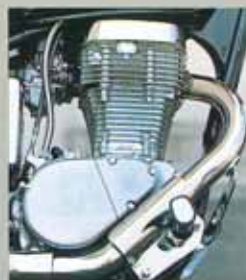
● 片側に刻まれた17枚の冷却フィンが美しい652cc単気筒エンジン。● 二重管構造でヘビーなサウンドを奏でるエキゾーストパイプ。● SAVAGEのロゴマークが光るラジエーターサイドカバー。
