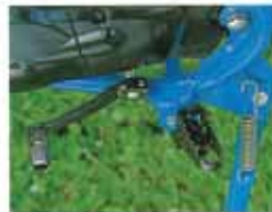
●6段リターン式ミッションと、破壊しにくい可倒式チェンジレバー。
