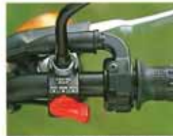
●大型キルスイッチと転倒時のダメージを防ぐサイドプル方式スロットル。
