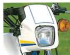
●35W/35W大容量のメーターバイザー一体の角型ヘッドライト。
