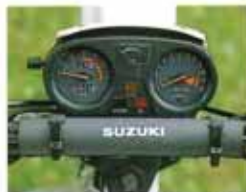
●タコメーター/水温計装備。機能的なレイアウトのメーターパネル。
