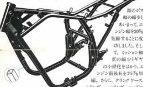
除外、中空カムシャフトの採用など、細部にわたり大胆なシェイプアップをほどこしたエンジン全体の重量(キャブレター・エアクリーナー含む)は76kgと従来のものより13kg軽量化に成功。まさにコンパクトでハイパフォーマンスなエンジンの誕生です。フレームは、軽量かつ剛性も高いハイテンション(高張力鋼)角パイプを採用。ハンドル、フロントステップ、ブレーキ&チェーンベルダルなどにアルミ鍛造パーツを使用するといった、材質面からも軽量化をねらいました。スズキの職人技だからこそなしあた、徹底したULTRA-LIGHT WEIGHT。GSX750Eの登場で、重い車体をひっぱるよう、エンジンをうながせる時代は、すでに過去のものとなろうとしています。
