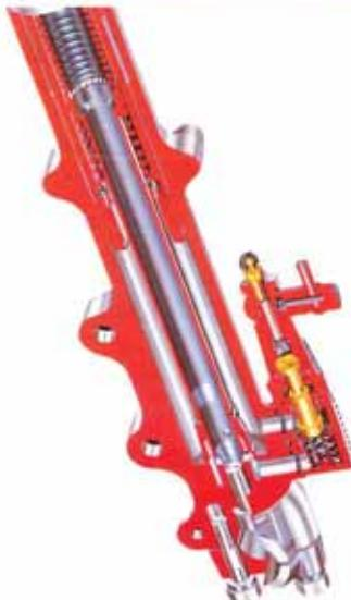
ションとしての機能を果たします。加えて、ANDFの採用により、サスペンションのセッティングをソフトにでき、ノーマル走行における乗り心地を、さらに快適なものにしています。より速く、よりライダーへの負担を軽く——コンマ1秒を争うレースで鍛えぬかれ、そして、現在もRGΓ、GS1000Rに栄光をもたらすANDF。アグレッシブ・マルチ GSX750Eにこそふさわしい、スズキ・レーシングテクノロジーのフィードバックです。
