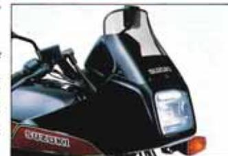
いま、モーターサイクルはフェアリングの時代に突入しつつあります。しかし、こうしたフェアリングのなかには、デザインのみに重点がおかれ、重量や空気抵抗の増大によってマシンの走行性能を損なうものもあります。スズキが、このGSX750Eにおいて追求したのは、あくまで“走り”的なフェアリング。軽量・コンパクトでありながら、優れた空力特性と整流効果を発揮するフェアリングの開発でした。このウェッジシェイプのハーフフェアリングこそは、まさにそのひとつの中です。走行時の空気抵抗を減少させ、優れた整流効果によりダウンフォースを発生し、安定した高速走行をもたらします。モーターサイクルの運動特性を極めたコンパクトフェアリング。風をもライダーの味方に変える、先進の装備です。
