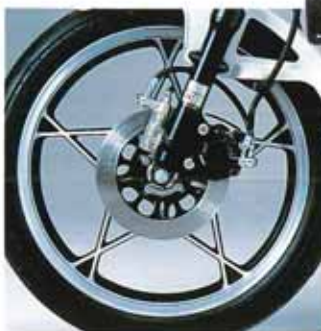
快適な乗り心地と小気味よいフットワークのANDF機構、シャープな制動力の前輪油圧ディスクブレーキ。
