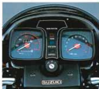
便利なギヤポジション・インジケータースタック。大きくて見やすいレイアウトの角型メーター。
