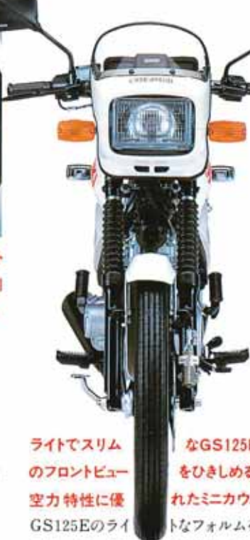
快適な乗り心地と小気味よいフットワークのANDF機構、シャープな制動力の前輪油圧ディスクブレーキ。
