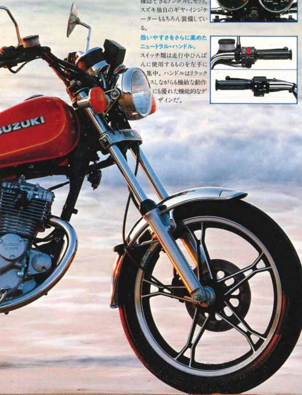
シンプル・アメリカンにふさわしいシンプルなメーター類。大径のスピード&タコメーターを最小限の視線移動で確認できるアングルにセット。スズキ独自のギヤ・インジケーターもちろん装備している。
