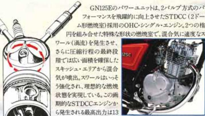
GN125Eのパワーユニットは、2バルブ方式のパフォーマンスを飛躍的に向上させたSTDCC(2ドーム形燃焼室)採用のOHC・シングル・エンジン。2つの機能を組み合せた特殊な形状の燃焼室で、混合気に適度なスワール(渦流)を発生させ、さらに圧縮行程の最終段階では広い面積を確保したスキッシュ・エリアから混合気が噴出。スワールはいつそう強化され、理想的な燃焼状態を実現している。この画期的なSTDCCエンジンから発生される最高出力は13
