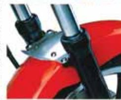
RCPL(リモート・コントロール・ブリード)リヤサスの初期荷重をリモートコントロールできるRCPL。タンデム、ソロなどの走行状態や、路面に合わせたセッティングが可能です。前足のふんわり、スタビライザー。フロントフォークの剛性を高めるスタビライザー。後方にせりあがったFINは、ラジエーターへの集風効果に優れ、エンジン冷却に貢献します。
