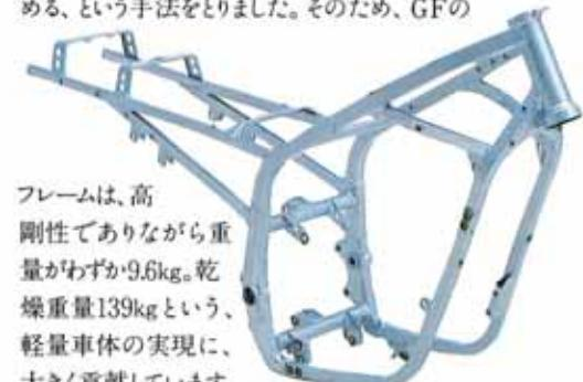
フレームは、高剛性でありながら重量わずか9.6kg。乾燥重量139kgという、軽量車体の実現に、大きく貢献しています。
