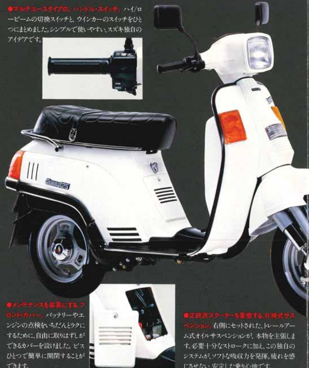
●メンテナンスを容易にする、フロント・カバー。バッテリーやエンジンの点検をいちだんと楽にするために、自由に取りはずしができるカバーを設けました。ビスひとつで簡単に開閉することができます。
