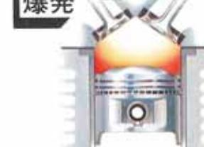
●燃焼室内中央近のスパークプラグ●燃焼スピードがきわめて速い・全体が均一に燃焼・燃焼効率向上
