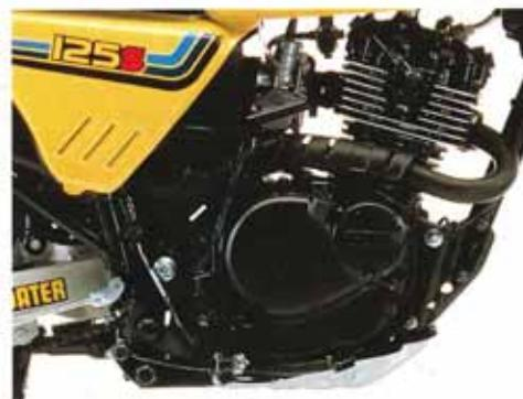
DR125Sの心臓部は、2バルブ方式のバーフォーマンスを飛躍的に高めた、あのSTDCC(2ドーム形燃焼室)を採用。2つの楕円を組み合わせた獨得な燃焼室形状により、良好なスワールと、そのスワールをさらに強化するスキッシュ効果を作りだすことにより、燃焼効率は飛躍的に向上。低中速
