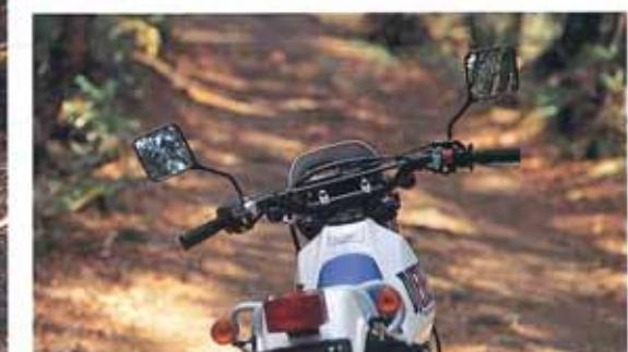
軽快なパワーユニットは、燃費効率と輸送コスト化を両立させたミディアム級市販車初実験用エンジンは、最高出力14ps/9500rpm・最大トルク14kgm/8000rpmを発揮。扱いやすい油力特性により、ガルフスターー操縦により、走行時や止歩歩行時の再起動でもオージーエラー。乗り手を選ばないや特徴エンジン。快速なサスペンション。フロントフォークはしなやかな乗車感を中心とした式。リヤはリンク式サスペンション。オンオフを問わず優れた衝撃吸収力を發揮して、ソーリングもスポーツランも快適。わだらなどのある林道や走りい地でも、常に安定した走行をキープ。
