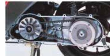
ト駆動による自動無段変速。要するにアクセル操作だけですむオートマチックですね。カーナでは、さらにトルクセンサー(キックダウン機構)を装備。急加速や登
