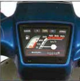
●メーターパネル 見やすいレイアウトでまとめたメーターパネル。電気式の燃料計を内蔵しています。(スーパー・テラックス、カスタム、スーパーカスタムに採用)
