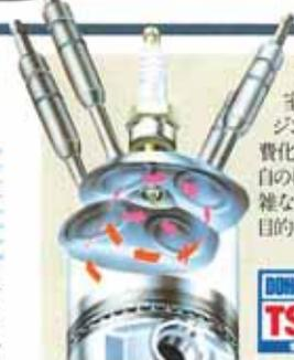
TSCCは、2渦流燃焼室の略で4ストロークエンジンのハイパワー化と、低燃費化を実現させたスズキ独自の機構です。その特徴は、複雑な補助機構を必要とせず、目的を達成したことにあります。
