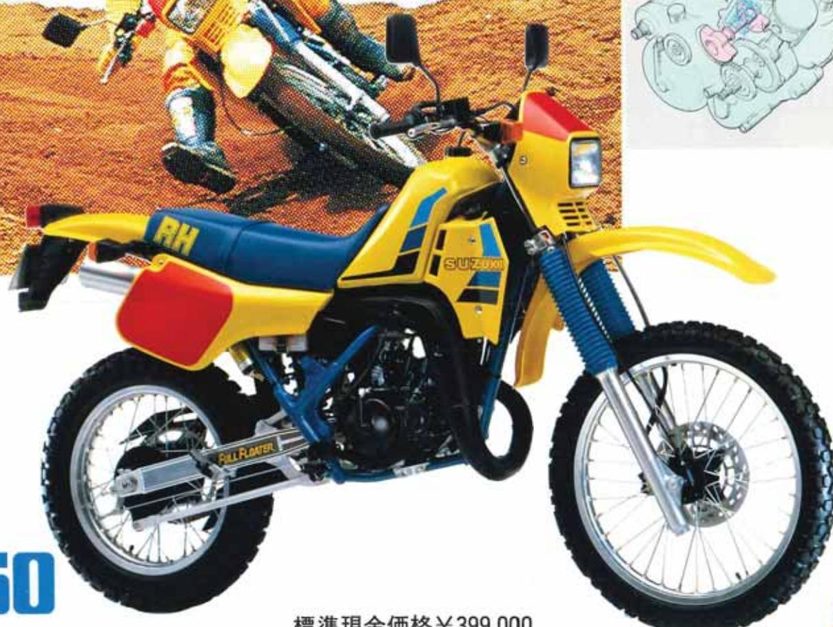
幾多のチャンピオンマシンを生んだスズキのスーパーメカニズムが生きづく、2ストロークのパワーユニット。①②③ 35ps/7,500rpmの最高出力、3.4kg-m/6,500rpmの最大トルクを発揮するエンジンは、レースで培われたメカニズムをフィードバックしています。シャープなレスポンスを生み出すフラットスライドキャブレターに、AAR(自動高度補正機構)の採用により、高地での気圧変化にも全回転域で最高の混合気をシリンダーに送り込みます。排気システムは、スズキ独自の多段膨張マフラーを採用。高い排気効率と燃焼効率の大幅な向上が実現しました。ラジエターは軽量、小型の分割タイプのアルミ製で、高い放熱効果を持っています。冷却水の循環経路を最短距離にとるスズキ独自の冷却システムを構成しています。一軸式のバルンサーを内蔵し、低振動、低騒音と、エンジンの軽量、コンパクト化を実現しています。
