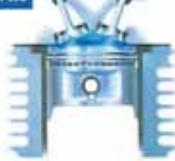
圧縮行程においては、ピストンとシリンダーヘッドとの間に設けられたスキッシュ・エリアから混合気が燃焼室中央へと噴出し、混合気のかくはんがさらに行なわれます。
