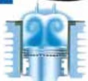
気筒入り2つのインテークマニホールドから短時間に大量の混合気が吸入されます。燃焼室ループの形状により、2つのスワールが発生し、混合気の高密度化を促進します。
