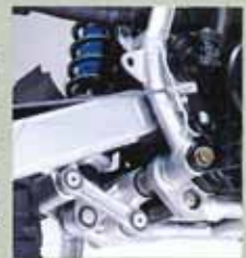
▲ボトムリンク式ユニトラックスサスペンション
