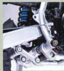
▲ボトムリンク式ユニットラック、 サスペンション
