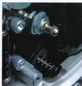
ボトムリンク式ユニトラックスサスペンションアジャスター (上)エアバルブ：無段階プリロードアジャスター (下)フル式4段階ダンパーアジャスター
