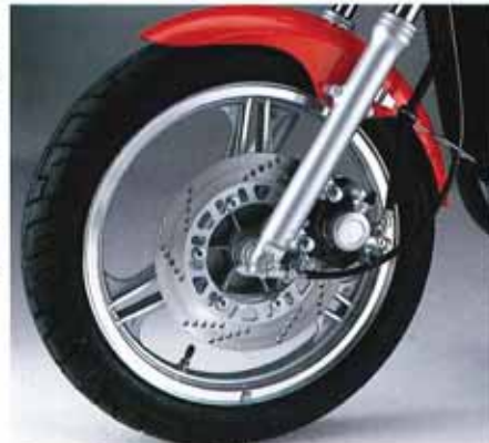
●ニューキャストホイールに装着された16インチタイヤ&ディスクブレーキ
