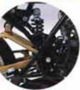
上級クラスやレーサーに使用されているユニットラックサスペンションシステムを搭載し、コンパクトなボディながらも、走りは本物を追求しています。ソフトなクッション特性とコーナーでの踏んぱりは、よりシャープな走りを追求したもので、フロントの不等ピッチ多孔式ディスクブレーキとともにフットワークをガッチャリ固めています。
