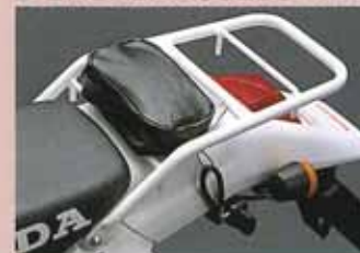
●リアキャリア 08L42・KCZ-000 ¥8,000(取付時間0.2h) ロングワングに頼もしい、許容積載量5kg、テールバッグとの併用可能。
