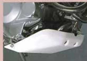
●スキッドプレート 08P51・KCZ-000 ¥8,500(取付時間0.2h) 弾力性に富み、割れにくく錆びない樹脂製。
