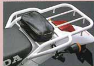
●フイディアキャリア 08L47・KCZ-A00 ¥9,500(取付時間0.2h) 全幅8.1mmの大径サイズ、許容積載量5kg、テールバッグとの併用可能。
