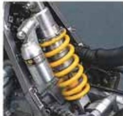
ビギンバック型ダンパー (サブタンク一体式) ※写真は撮影のため ハーネスの変更と一部の部品を 取りはがしています。
