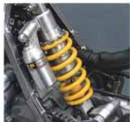
ビギンバック型ダンパー（サタンクータイプ） ※写真は撮影のため ハーネスの変更と一部の部品を 取りはずしています。
