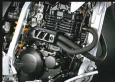
トルクフルな走りを生み出す400cc空冷4ストロークエンジン
