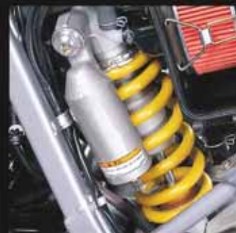
リアサスペンションはビギンバック型ダンパー採用
