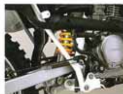
荒れた路面でも柔軟な路面追従性をみせるブロリンクサスペンション
