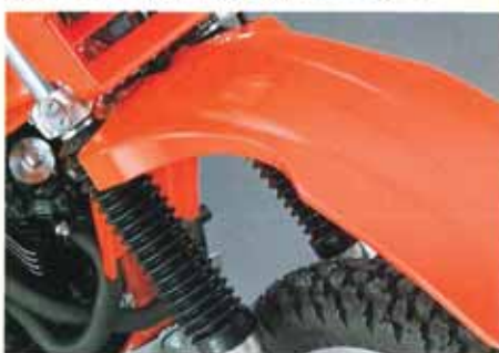
エンジンへ冷却風を導く、大型フロントフェンダー。
