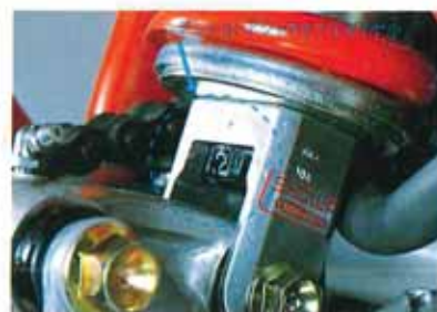
強靱な高張力鋼管スイングアーム。 オフロード走行に要求される高剛性を備え、かつ軽量の角型断面中空スイングアーム。
