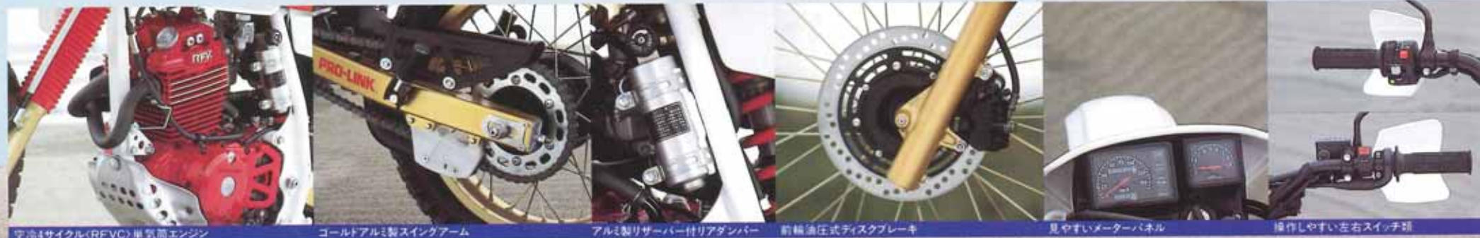
空冷4サイクル(RFVC)単気筒エンジン
