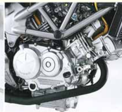
熟成を重ねた水冷4ストロークDOHC90度Vツインエンジン。
