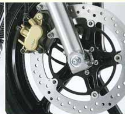
強力な制動力を発揮するφ296mmフロントディスクブレーキ。
