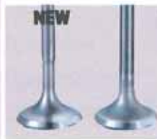
①肉抜きにより大きく軽量化されたピストン ②軽量化と同時に通気抵抗を減らした吸・排気バルブ ③ダブルプッシュローラーになったカムチェーン
