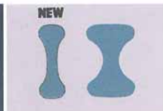
この断面写真のように、表面硬化処理により外周部に極めて硬い層を形成。薄い肉厚を可能としたハイパー・コンロッド
