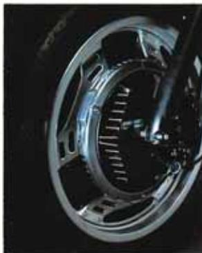
イールに固定されているため、きわめて鳴きにくいディスク・ブレーキとなりました。さらに、ディスクブレートは、ブレーキフィーリングの良い鋳鉄を採用。“真綿フィーリング”的効き味”をもたらしています。またコムスター
