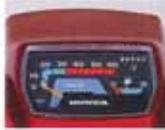
大型で読みとりやすいスピードメーターを中心的に。スイッチを切ってもガソリン残量を表示し続ける電気式燃量計、オイル交換時期を知らせるとオイルインジケーターをレイアウト。シンプルで見やすい。
